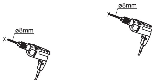
Perfurar a parede nos locais marcados utilizando uma broca de ø8mm.
